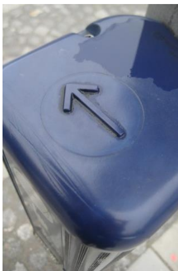
Slika A: Ustrezno opremljen zvočni semafor. Slika B: reliefna puščica na vrhu škatlice semaforja slepi osebi sporoči smer v kateri lahko prečka cesto. Slika C: Na navpični stranici škatlice semaforja lahko slepi otipa postavitev prometnih pasov in dobi občutek o velikosti ceste, ki jo namerava prečkati.
